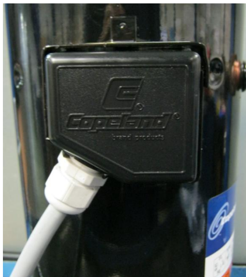
Рис. 22: Пример правильного подключения ZBD21K* с помощью кабельной муфты
