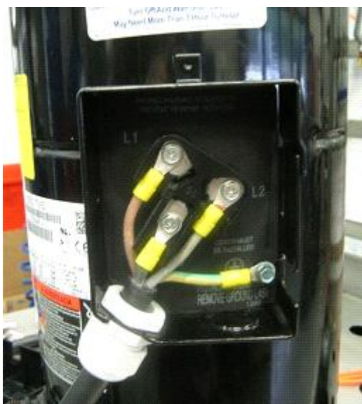
Рис. 23: Правильное электрическое подключение клеммной коробки IP21 с помощью кабельной муфты (компрессоры ZBD30K* - ZBD76K* / ZFD13KVE - ZFD25KVE)
